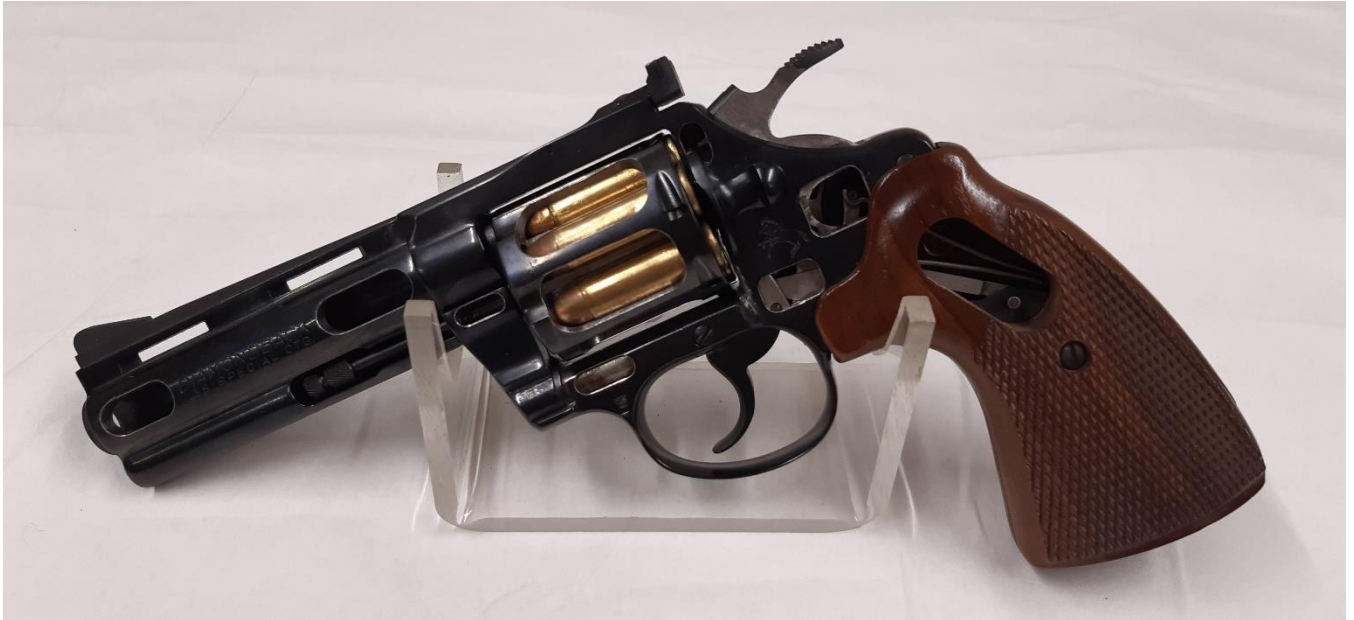
Neutralisation didactique d'un revolver COLT 38 Spécial
