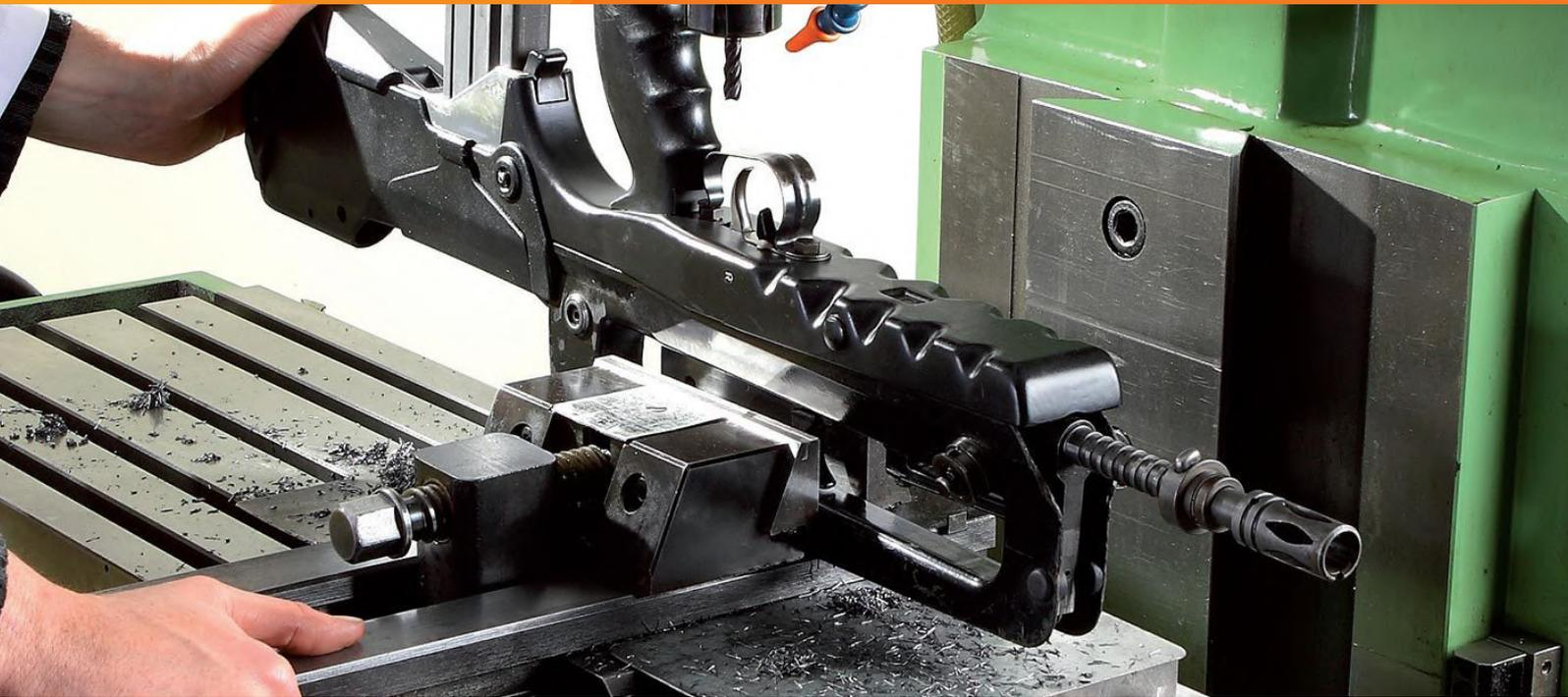
LE BANC NATIONAL D'ÉPREUVE RÉALISE LA NEUTRALISATION DES ARMES DE PETIT CALIBRE ET DES SYSTÈMES D'ARMES DE MOYEN ET GROS CALIBRES, IL PEUT ÉGALEMENT PROCÉDER À LA DESTRUCTION D'ARMES SELON LA RÉGLEMENTATION EN VIGUEUR
